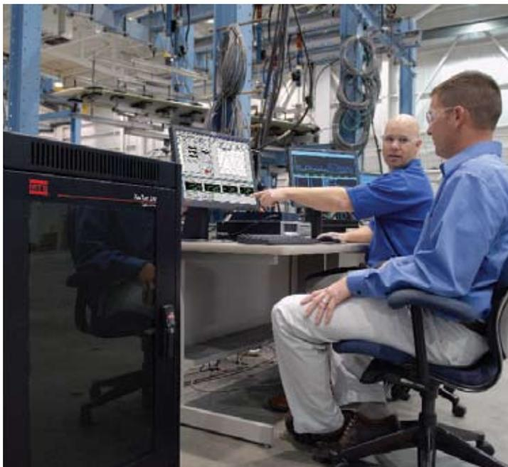
de MTS dans la livraison et l'assistance de plusieurs milliers de contrôleurs numériques dans le monde entier. Cette nouvelle gamme de contrôleurs assure un contrôle en boucle fermée, une génération de fonctions, un conditionnement de capteurs et une acquisition des données à grande vitesse afin de traiter l'éventail complet des besoins en matière d'essais.
